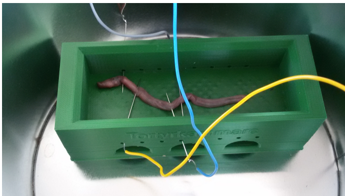
Figur 5. Dagmaskuppkoppling för försök 1 och 2. Blå och grå nålelektrod för stimulering, övriga för registrering.
