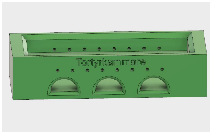
Figur 16. Färdig mätkammare i programmet Autodesk Fusion 360 [13].
