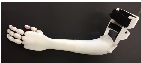
Figur 1. Den slutgiltiga prototypen med hylsa anpassad efter användaren. Protesen spänns fast på patientens överarm och kan sedan manövreras med endast böjning i armbågen.
