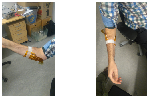
Figur 1: Placering av elektroder för kontroll av handrörelser.
