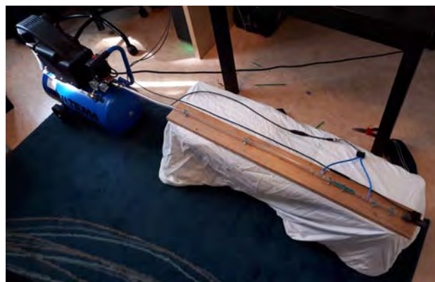
Figur 5. Slutgiltiga testriggen som användes vid mätningarna. Sensorer och flödesmotstånd är inkopplade till höger i bild. [17]
