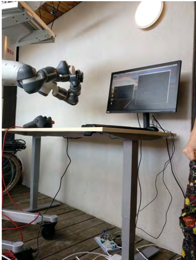
Figur 4. Försök med seriekopplade sensorer, höj-och sänkbart bord samt YuMi-robot
