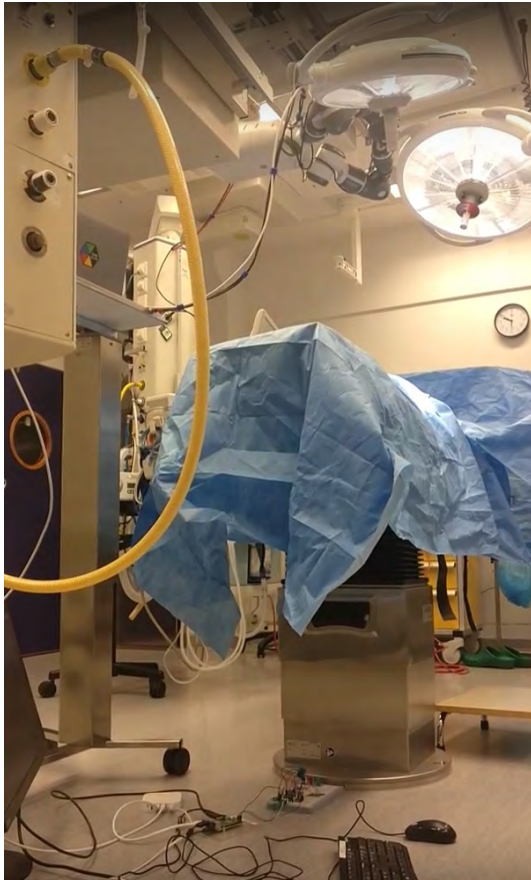
Figur 8. Brits i operationssal med kopplingsdäck och Raspberry Pi undertill. YuMi-robot syns ovanför liften.
