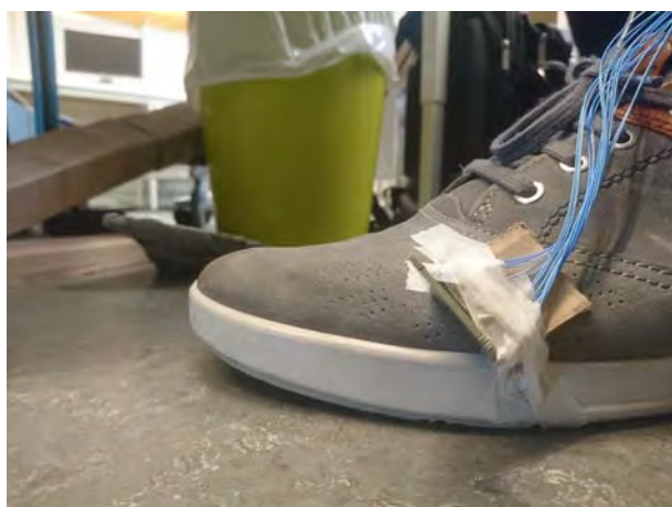
Figur 5. Hur radarn placerades på utsidan av foten. På bilden är den vinklad 45° mot marken.
