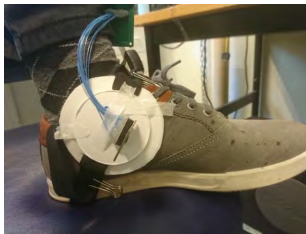
Figur 6. Hur radarn placerades på insidan av foten. På bilden är den vinklad 60° mot marken.
