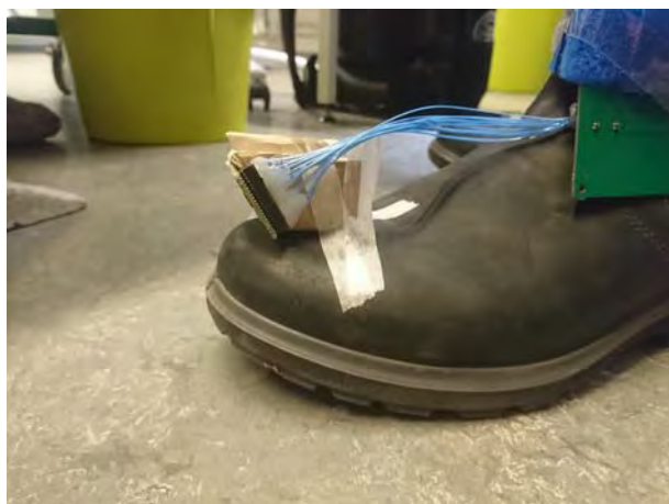
Figur 4. Hur radarn placerades längst fram på foten. På bilden är den vinklad 60° mot marken.
