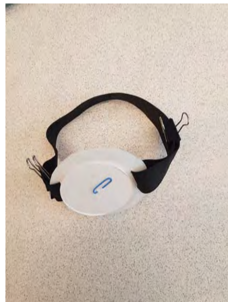
Figur 3. Fästeanordningen som användes i huvudstudien. Radarn tejpades fast på den mindre plastcirkeln.
