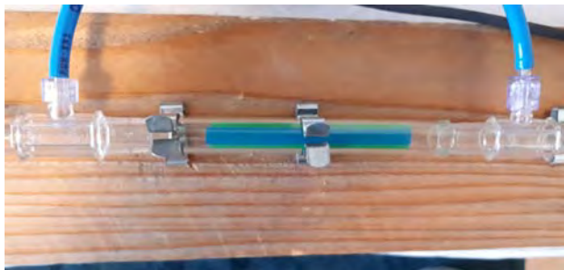
Figur 7. Flödesmotstånd monterad i testriggen. Blå slangar uppåt i bilden leder till differentialtrycksensorn, luftflödet rör sig åt höger i bilden mot luftflödessensorn. [17]
