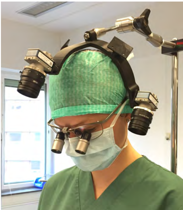
Figur 6. Fotografi från test av kamerahållare på kirurgs huvud i operationssal. Hållaren är monterad på en prototyp av robotarmen och två av fem kameror är monterade. Från fotografiet ses tydligt att kirurgens lappar och kameror är riktade åt samma håll vilket gör att kirurgens synfält kan återges.
