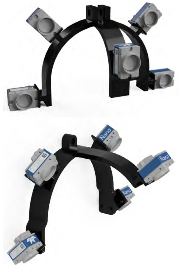
Figur 5. Rending av kamerahållaren med kameror. Övre bild: första version. Undre bild: modifierad version.
