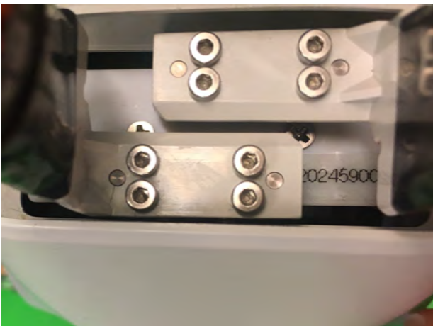
Figur 2. Bild på YuMi-robotens fäste på gripdonet. Fästansordning består av fyra skruvar per finger.
