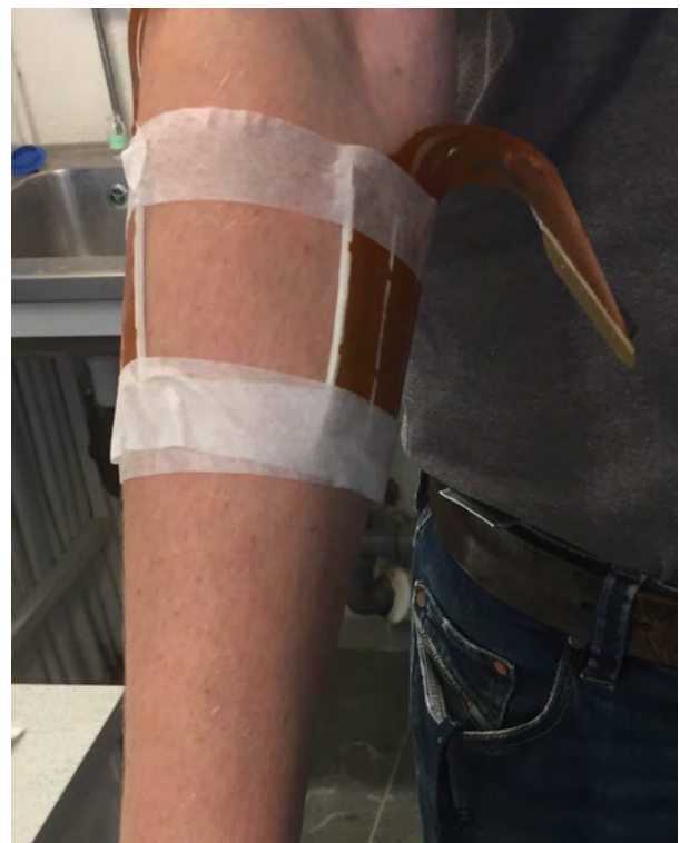
Figur 7. Elektrodena fastsatta och fixerade med tejp längs ytterkanterna.
