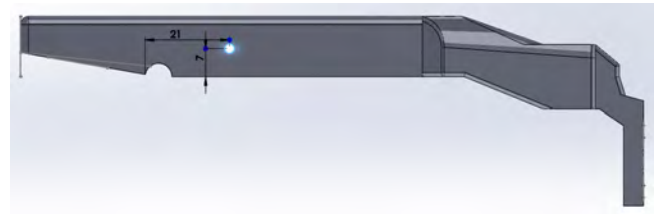
Figur 16. SutureShark 's stora del som slutgiltig CAD-modell ritad i Solidworks med utsatta mått av vart hålet till klädnypans fjäder är utplacerad. Mått i millimeter.
