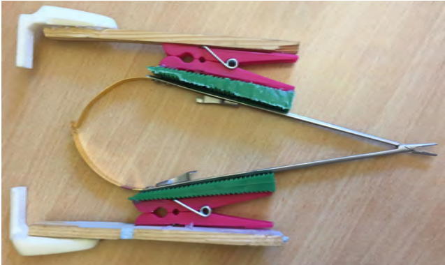
Figur 6. Klädnypeprototypen tillsammans med robotfingrar och nålförare. Klädnyans fjäder är den led som följer nålförarens vinkelförändring då robotfingrarna öppnas och stängs.
