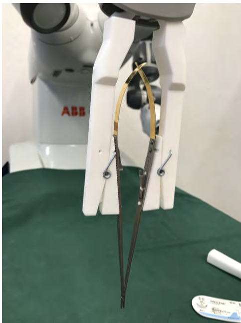
Figur 10. Bild på det vinnande konceptets slutgiltiga 3D-print, SutureShark , fastskruvad på roboten hållandes i nålföraren. Här är fingrarna öppna och även nålföraren. Lägg märke till förändringarna i vinklarna vid klädnypefjädersn.
