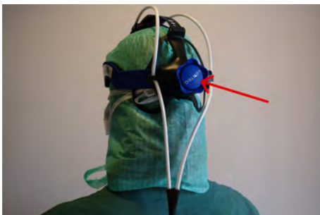
Figur 6: Pilen visar spänningsreglaget på kirurgens ljuskrona.
