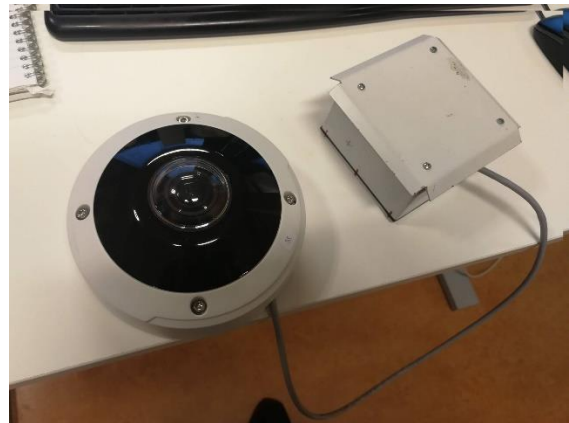
Figur 1: En nätverkskamera tillsammans med tillhörande näsa. I detta fall form av en kvävedioxidsensor.
