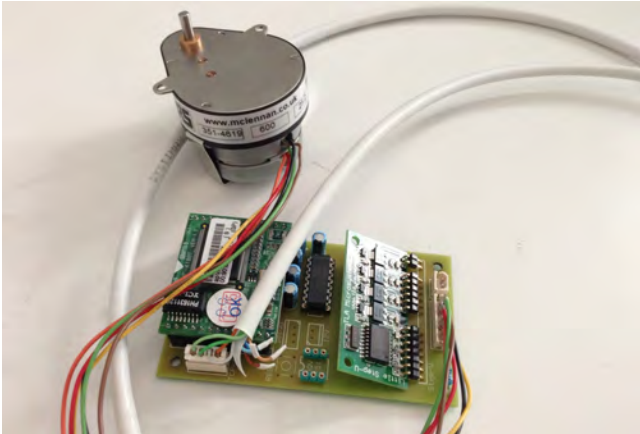
Figur 8. Kretskortet med stegmotorn som använts vid slit-sampler bygget.
