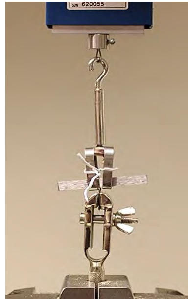
Figur 7. Slutlig version av hållaren. Del B byttes ut mot en aluminiumtråd som fästes i en klämma. Ringarna hölls samman med hjälp av en metalltråd för att inte glida i sär under utdragstesterna. Bilden togs under ett utav utdragstesterna.
